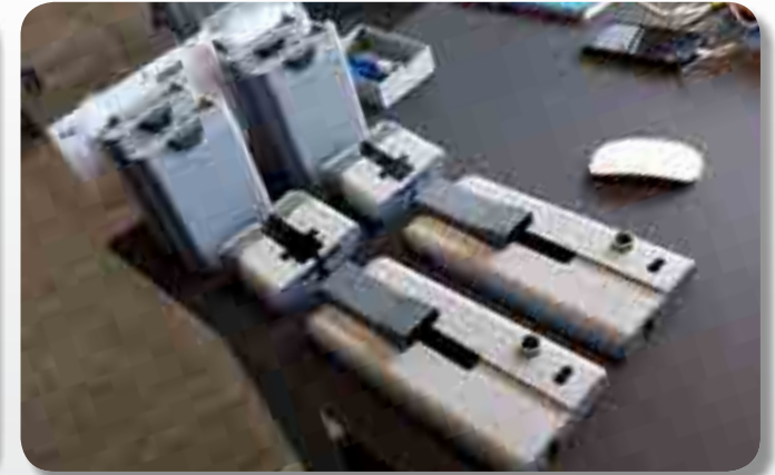
Différentes parties de la coque, imprimées en frittage et peintes par un industriel externe.
