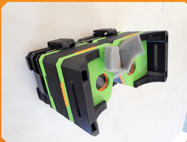
Prototype de casque assemblé après l'impression 3D des différents éléments.
