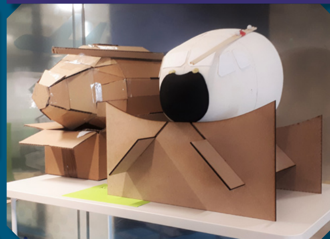
Les maquettes en mousse et en carton du nez de l'avion.
