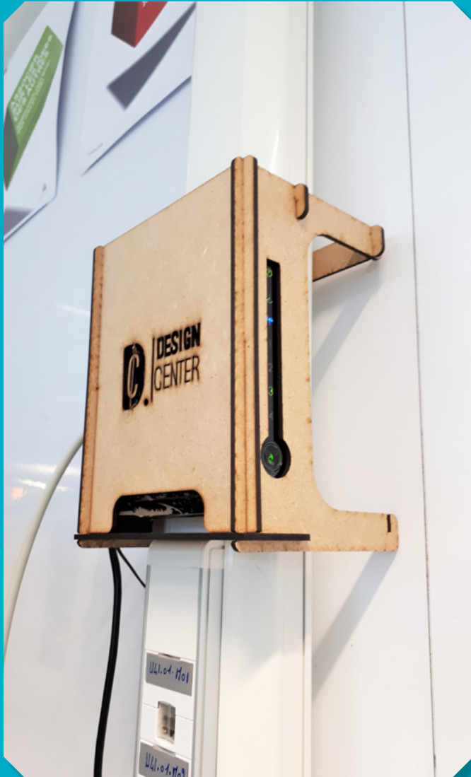
Boîtier découpé au laser, assemblé et installé sur la colonne.
