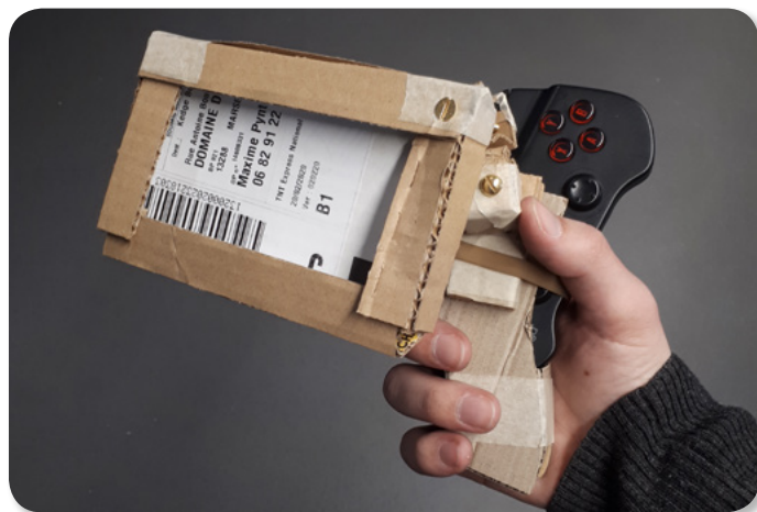
Le prototype de manette Bluetooth, avec un concept d'écran intégré.
