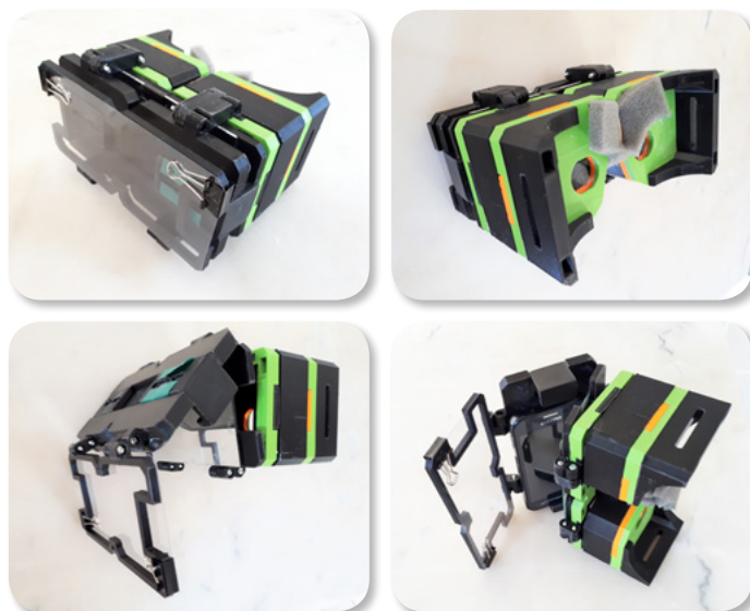
La deuxième version du casque imprimé en 3D avec les nouvelles pièces intégrées.
